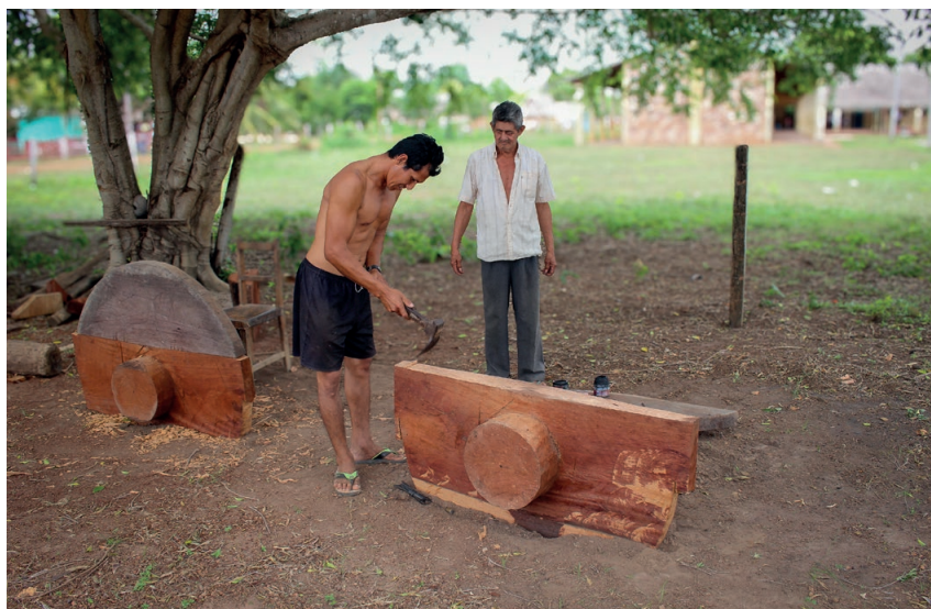
Construcción de ruedas de carretón, comunidad Orobayaya.
